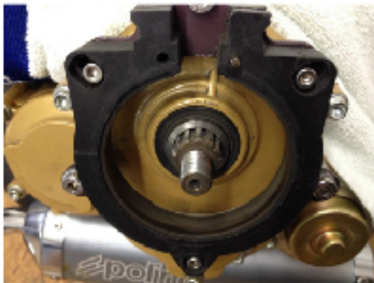
Kurbelwellen Zapfen mit Druckring Gewinde M12x1,25 LINKSDREHEND !
