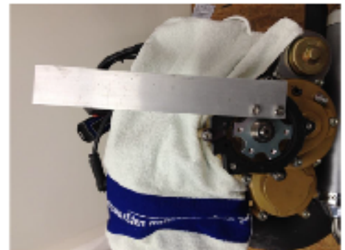
Montagehebel (fertigen) anbringen und Zentralmutter M 12x1,25 Linksgewinde mit Loctite Schraubensicherung montieren
